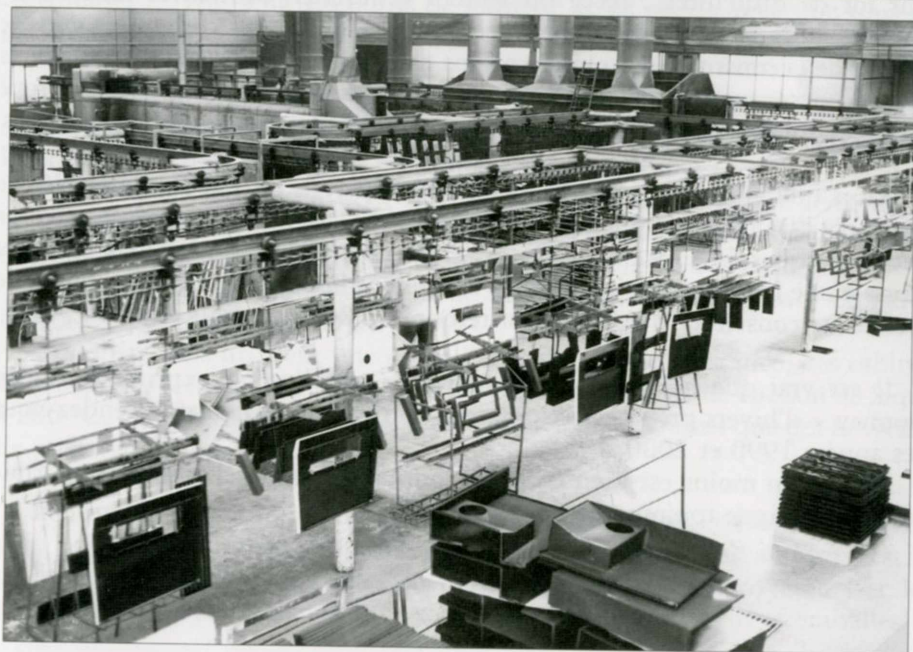
Le nouveau cubilot et le train de moulage en continu (haut) et la chaîne d'émaillage (bas).
